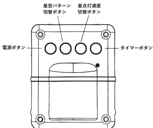
・電源ボタン---短く押すと電源がオンになり、長押しすると電源がオフになります。
